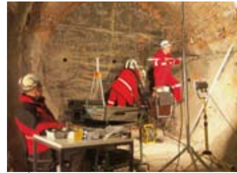
Mesures géophysique dans les argiles à Opalinus du laboratoire souterrain du Mont Terri
