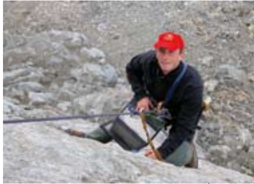
Lecture d'un logger dans les falaises à l'aide d'un ordinateur portable sous la station de Corvatsch-Gipfel.
