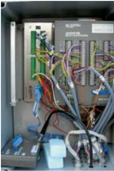
Loggerbox pour le forage de 60 m de profondeur percé en 1987 dans le glacier rocheux de Murtèl-Corvatsch.
